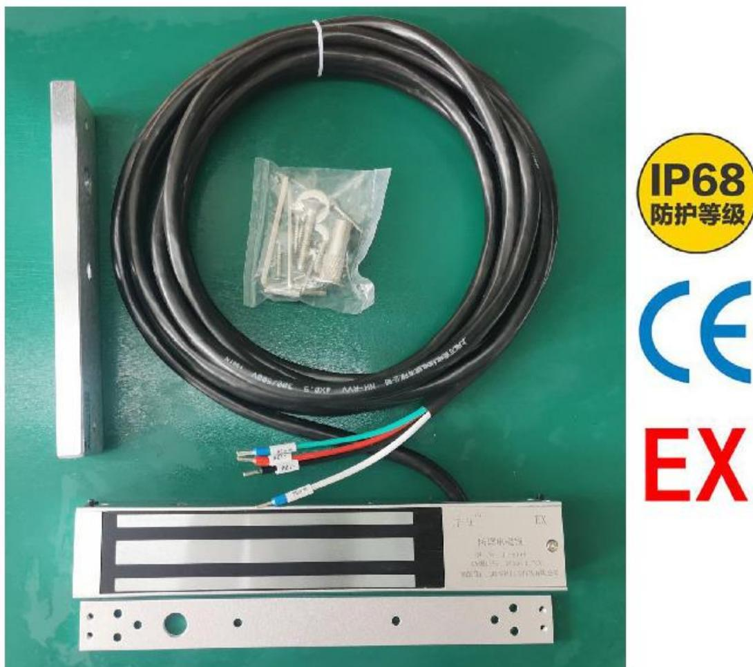
井田 JT-6000 防爆电磁锁能够使用在易燃易爆气体环境中，采用浇封防爆型，无需加装安全栅隔离设备的电磁锁，有结构简单、便于安装维修、无磨损等特点，比电插锁寿命长，可靠性高，发生危险时断电解锁便于逃生，特别适用于石油采练、储存、化工、医药、纺织、印染等易燃易爆危险环境，具有很高的安全性。井田 JT-6000 防爆磁力锁产品的设计符合国际标准 GB3836.1-2010【易燃易爆环境第（1）部分 设备 通用要求】和【GB3836.9-2014 易燃易爆环境 第 9 部分 由浇封型“m”保护的的设备】、【GB 12476.1 - 2013 可燃性粉尘环境用电气设备 第（1）部分：通用要求】和【GB 12476.6 - 2010 可燃性粉尘环境用电气设备 第 6 部分：浇封保护型“mD”】中的有关规定。产品经国际指定的防爆产品检测机构检定合格。
