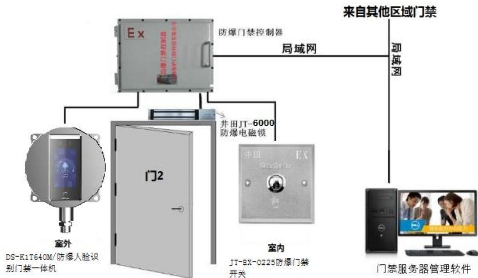
防爆门禁整套系统主要部件由海康防爆人脸识别一体机,井田 JT-6000 防爆电磁锁,井田 JT-EX-0225 防爆出门开关组成。海康防爆人脸识别一体机安装在危险区,井田防爆安全栅及门禁电源安在危险区的防爆箱内,防爆箱内可选配 UPS 电源,在整个系统出现意外故障断电的状态下仍然能继续正常工作,人员进出不受影响,且所有的进出记录均有保存。
