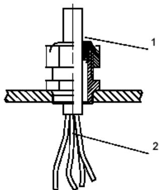
图3a 电缆引入装置
