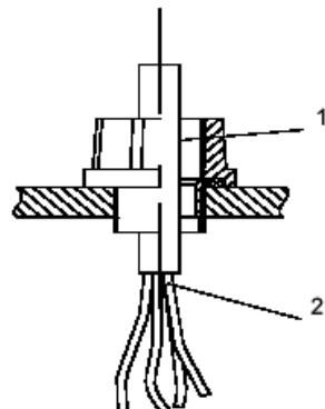
图3b 导管引入方式
