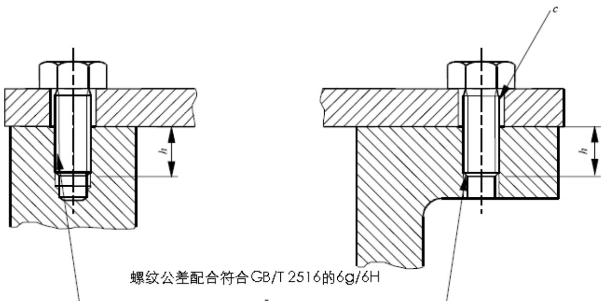
$h \geqslant$  紧固螺栓的螺纹外直径；
