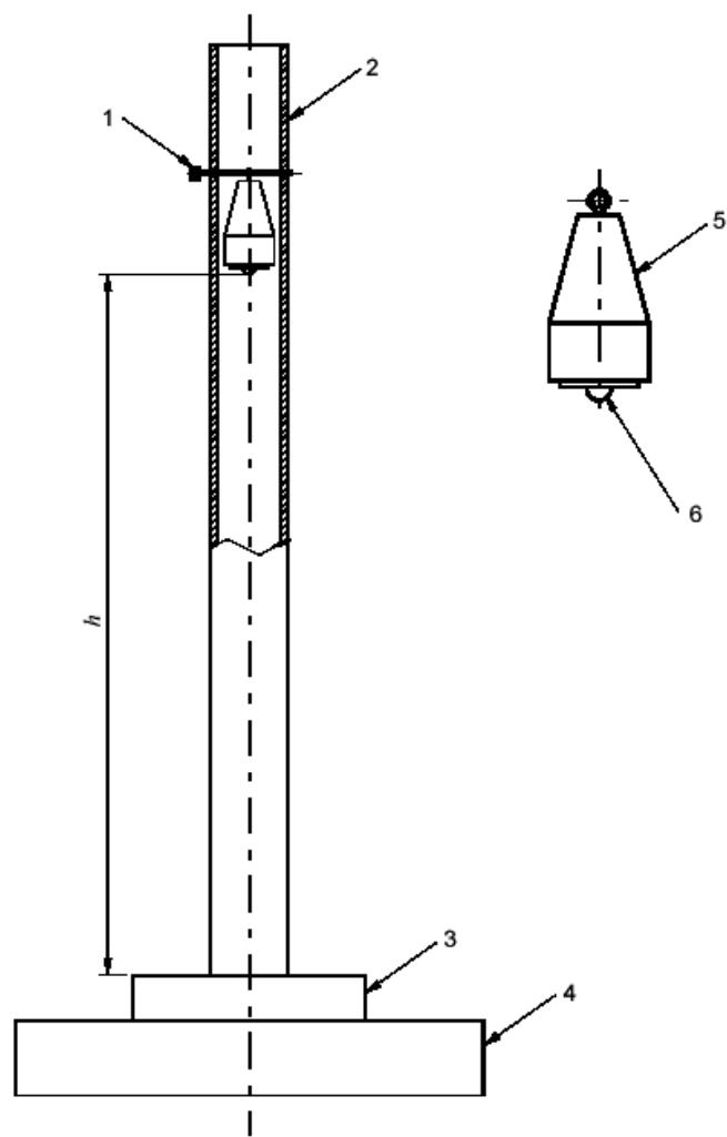
1—调整高度用螺栓； 2—塑料导管； 3—试品； 4—钢座(质量 $\geq 20\text{kg}$ )； 5—钢质锤体； 6—Φ25mm 锤头； h—坠落高度
